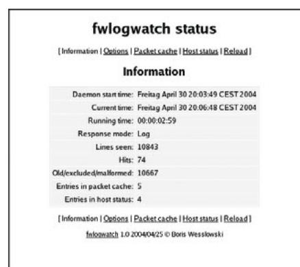
Figura 4: O servidor web embutido no fwlogwatch permite que o administrador monitore o estado atual do firewall.
