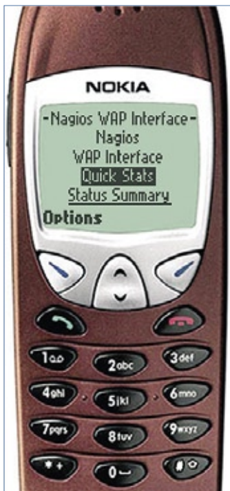
Figura 4 A interface WAP do Nagios é capaz de enviar um alerta para telefones celulares aptos a acessar a Internet.
