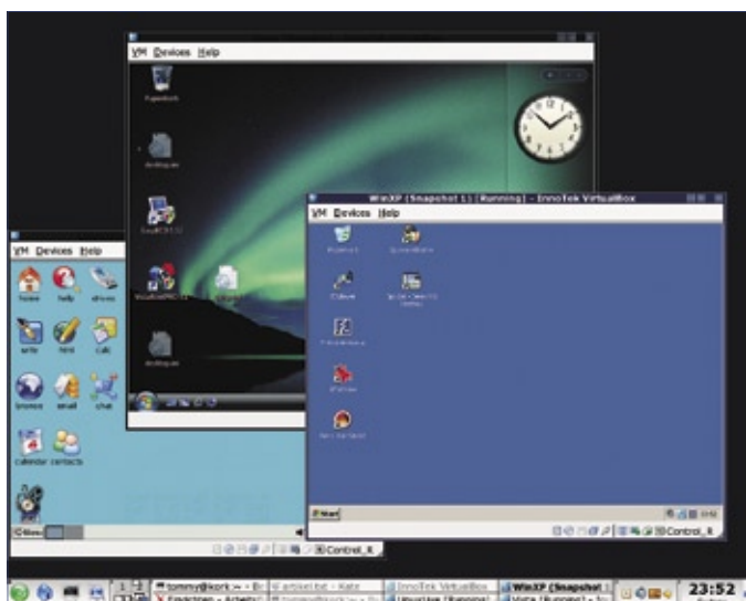
Figura 1 O VirtualBox abre máquinas virtuais como instâncias independentes em janelas separadas, permitindo que o usuário rode diferentes sistemas operacionais ao mesmo tempo.
