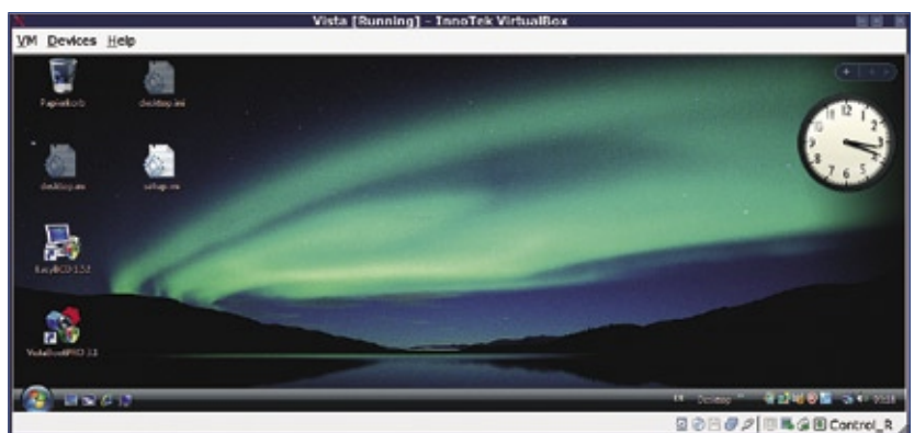
Figura 4 A função de redimensionamento automático do desktop modifica automaticamente o tamanho da janela do sistema hospede, de acordo com o tamanho da janela.
