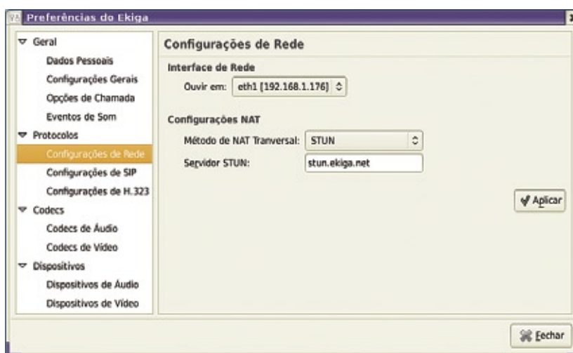
Figura 3 Um servidor STUN descobre o endereço IP de uma rede.
